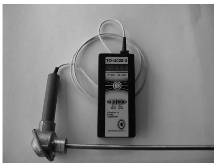
Рис. 1 Зовнішній вигляд ТОЦ-022-3 з тероперетворювачем ТО-010-3М
