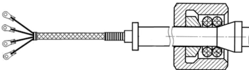
Рис. 5- Чертеж наружной части ТСП-0690 (рис. 2) с удлиненными выводами
