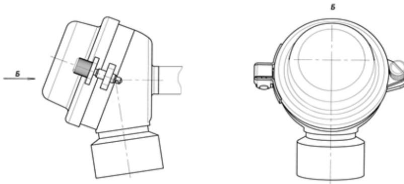
Рис. 3 - Чертеж наружной части ТСП-0690 (рис. 2) с головкой типа БАУИ.4087234.023 СБ
