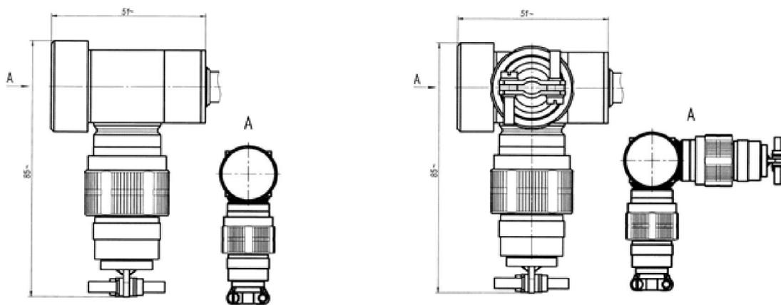
Рис. 4 - Чертеж наружной части ТСП-0690 (рис. 2) с головкой типа БАУИ.4087234.024 СБ
