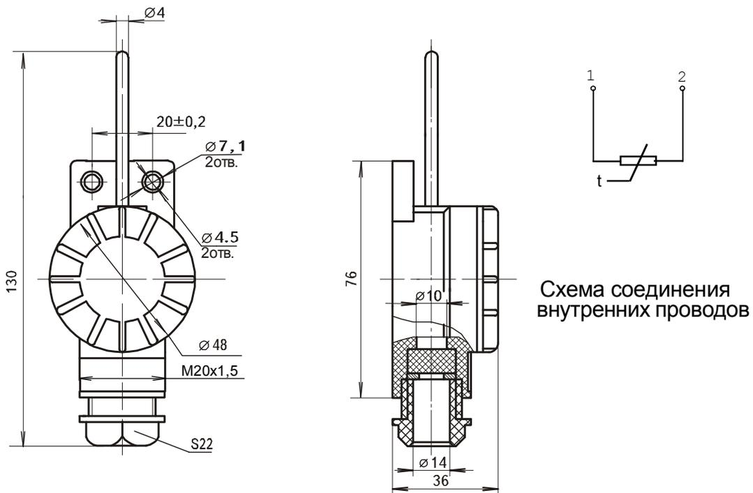
Схема соединения внутренних проводов
