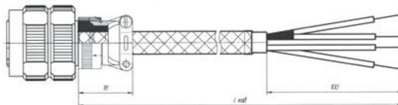
Рис.9 - Кабельная линия связи MULTITHERM 400-ES ТСП-1390 с соединителем УСНЦ144 для режима ТА
