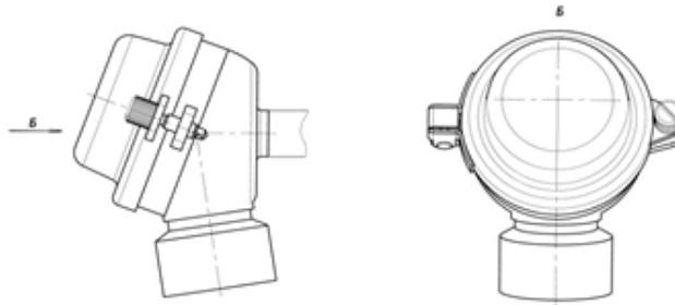
Рис. 7 - Чертеж наружной части ТСП-1390 с головкой типа БАУИ.408724.023 СБ
