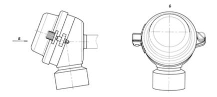
Рис. 7 - Чертеж наружной части ТХА-1690, ТХК-1690 с головкой типа БАУИ.4087234.023 СБ
