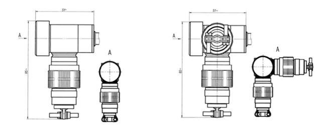
Рис. 8 - Чертеж наружной части ТХА-1690, ТХК-1690 с головкой типа БАУИ.4087234.023 СБ
