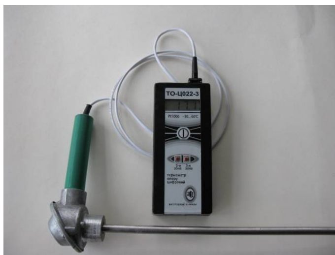
Рис. 1 Внешний вид ТОЦ-022-3 с термопреобразователем ТО-010-3М
