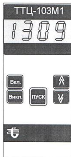
Рис. 2 - Мікропроцесорний термоелектричний термометр ТТЦ-103М1
