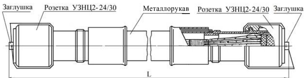
Рис. 5 - Габаритный чертеж жгутов ДП\*
